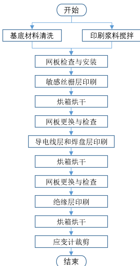
图2 碳基应变计制作工艺流程图
