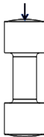
图6 柱式称重传感器弹性体示意图
